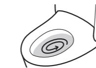
须知：根据坐在便座上的时间，大、小冲洗方式自动切换。
